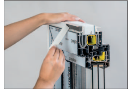
Aktivieren des integrierten Fugendichtbandes für den äußeren Leibungs- oder Rollladen-/Raffstoreanschluss.
